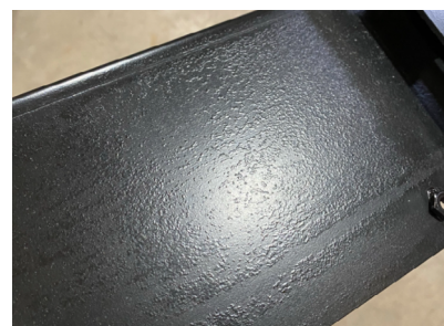
Afbeelding 3 - Gevolg van walshuid op blank materiaal (na voorbehandeling, zoals KTL)
