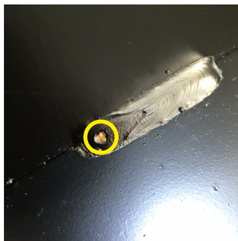
Afbeeldingen 8- Voorbeeld nadelig gevolg van silicaten op KTL laag
