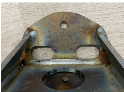
Afbeelding 2 - Gloeihuid op blank materiaal
